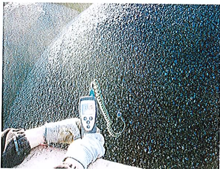
Température à la fabrication : 132.8 °c.
